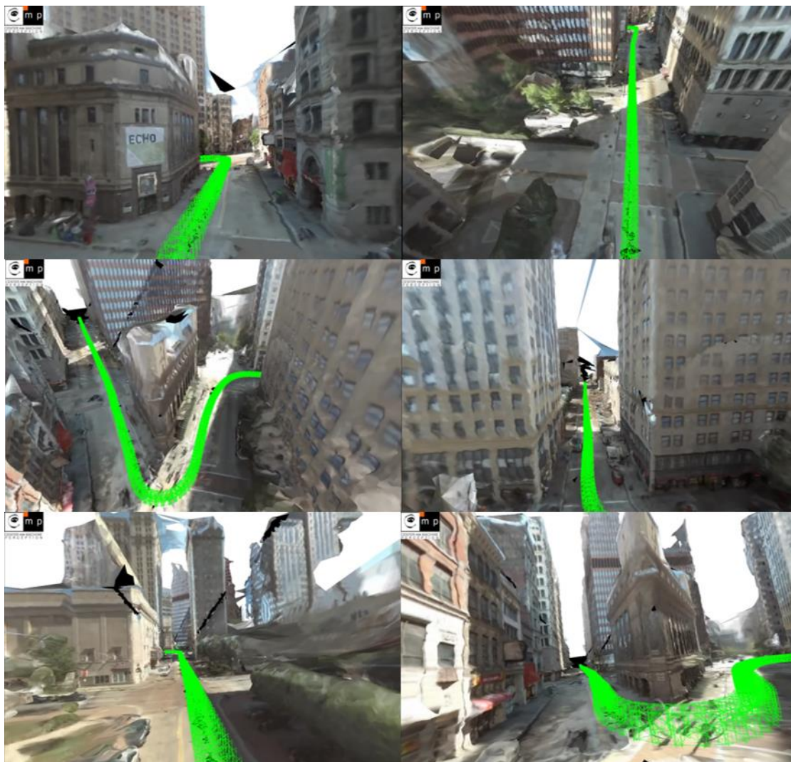
Fig. 8 Scanneamento 3D através de fotografias combinado com SLAM
